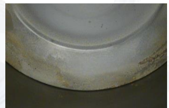
Abb. 2 - Kolbenkronenach mehr als 6.000 Bh Laufzeit mit SEVELUB®
