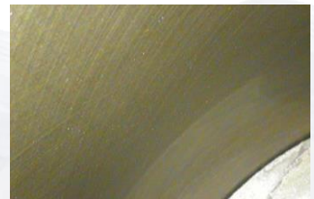
Abb.1 - Zylinderlaufbüchse nach mehr als 6.000 Bh Laufzeit mit SEVELUB®
